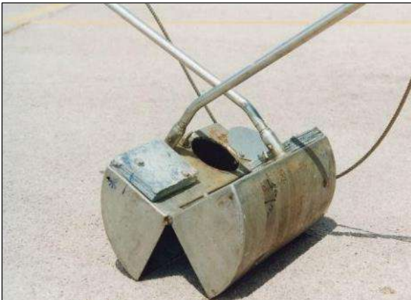
Figura 8.4: Esempio di benna Van Veen.
