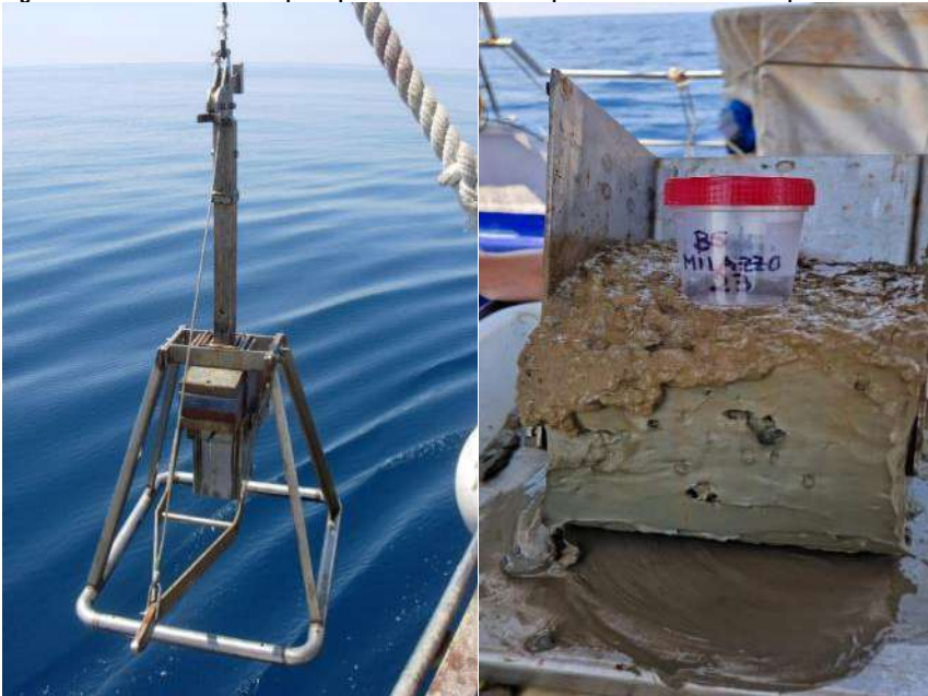
Figura 6.3: Box corer utilizzato per il prelievo di sedimenti e particolare del sedimento prelevato
