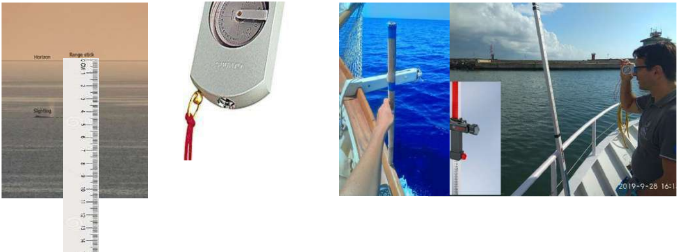
Figura 10.8: Calcolo della distanza per la corrispondenza con telemetro a righello (cm) e clinometro (gradi)
